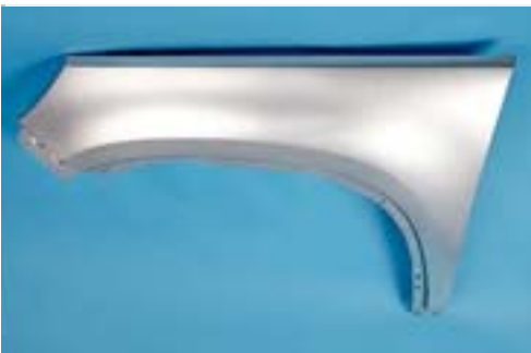
Prototyp-Kotflügel des VW Tiguan mit Überzug Stroncoat: So können Außenbauteile in korrosiv beanspruchten Zonen aussehen. Stroncoat kann sogar Gewicht einsparen Bild: Salzgitter Flachstahl
