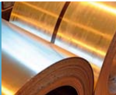
Magnesiumbleche könnten die Masse von flächigen Karosserieteilen weiter senken. Um sie „bezahlbar“ zu machen, fertigt MgF sie durch „Gießwalzen“ Bild: Magnesium Flachprodukte
