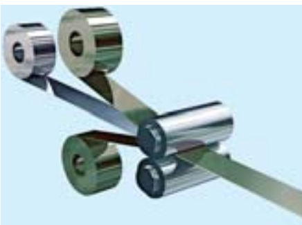
Plattierverbunde aus Aluminium und Edelstahl entstehen durch Kaltverpressen und Haftungsglühen. Sie sind umformbar und haben Leichtbaupotenzial Bild: Wickeder Westfalenstahl
