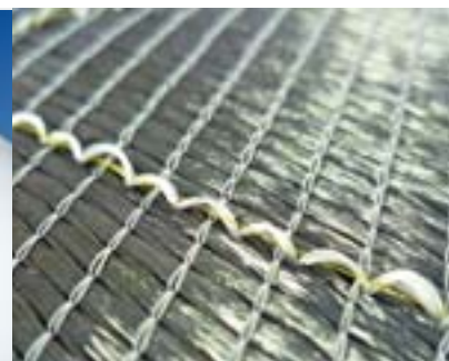
Das ITV Denkendorf erfasst Dehnungen in CFK-Profilen über faseroptische Sensoren (im Bild als gelber Faden zu sehen). Sie ermöglichen zuverlässige Messungen Bild: ITV
