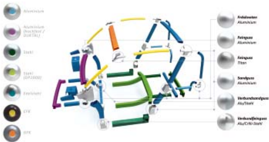
„Das richtige Material an der richtigen Stelle“ propagieren die FlexBody-Macher. Einen Überblick über den vorgeschlagenen Werkstoffmix gibt der eigens mit Unterstützung von Industriepartnern wie ThyssenKrupp System Engineering aufgebaute „Technologieträger“ Bild: Imperia
