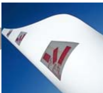
Das Monitoring-System FiberCheck erkennt Schäden in der GFK-Struktur des Rotorblatts: Eingestickte Kohlefaserrovings dienen als Dehnungssensor Bild: TU Chemnitz
