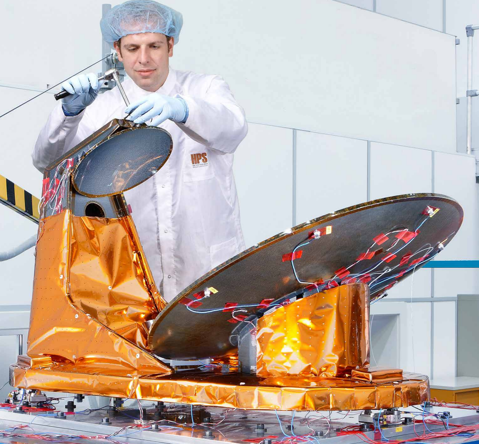
Vorbereitungen des STANT Antennensystems für die Vibrationstests © HPS GmbH Preparations of the STANT antenna system for the vibration tests © HPS GmbH
