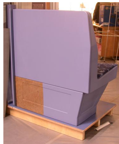
Abbildung 2: Eingebaute Sitzkasten- und Rückwandverkleidung aus FVK n. R.
